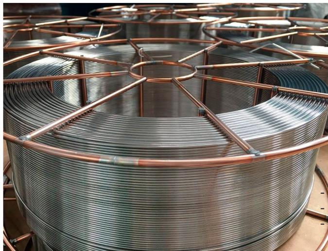
SG-2 - универсальная сварочная проволока, предназначенная для сварки изделий из конструкционных нелегированных и низколегированных сталей с пределом текучести до 420 МПа. Рядная намотка на катушки, стабильный диаметр по всей длине в сочетании с низким содержанием вредных примесей, таких как S и P, обеспечивают стабильное горение проволоки с минимальным разбрызгиванием и высокое качество наплавленного металла.
