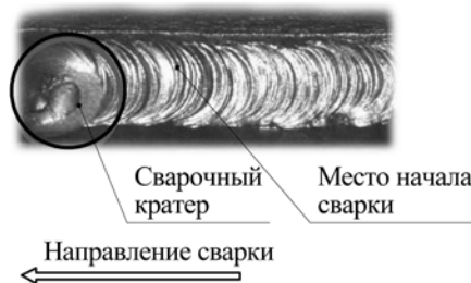
Рис. 9.4. Начало сварки при смене электрода.
